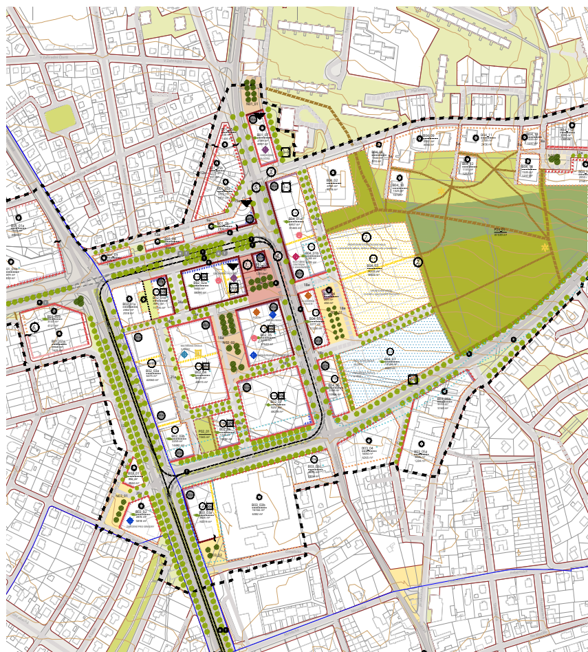
Územní studie Praha Nové Dvory, 2022 UNIT architekti, s.r.o. Příklad územní studie, která řeší formu zástavby do podrobnosti bloků, parcel i uliční sítě a nejvíce se tak vyjadřuje k rozvoji území s ohledem na urbánní resilienci.
