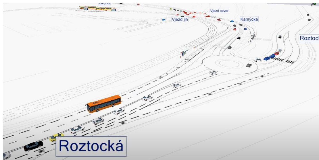
Obrázek 16: Křižovatka Kamýcká - Roztocká - výstup kapacitního posouzení pomocí mikrosimulace
