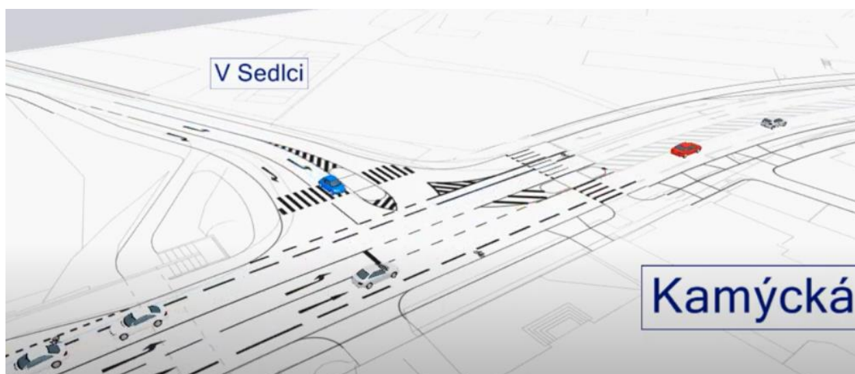
Obrázek 12: SSZ Kamýcká – V Sedleci – po dokončení SOKP - výstup kapacitního posouzení pomocí mikrosimulace
