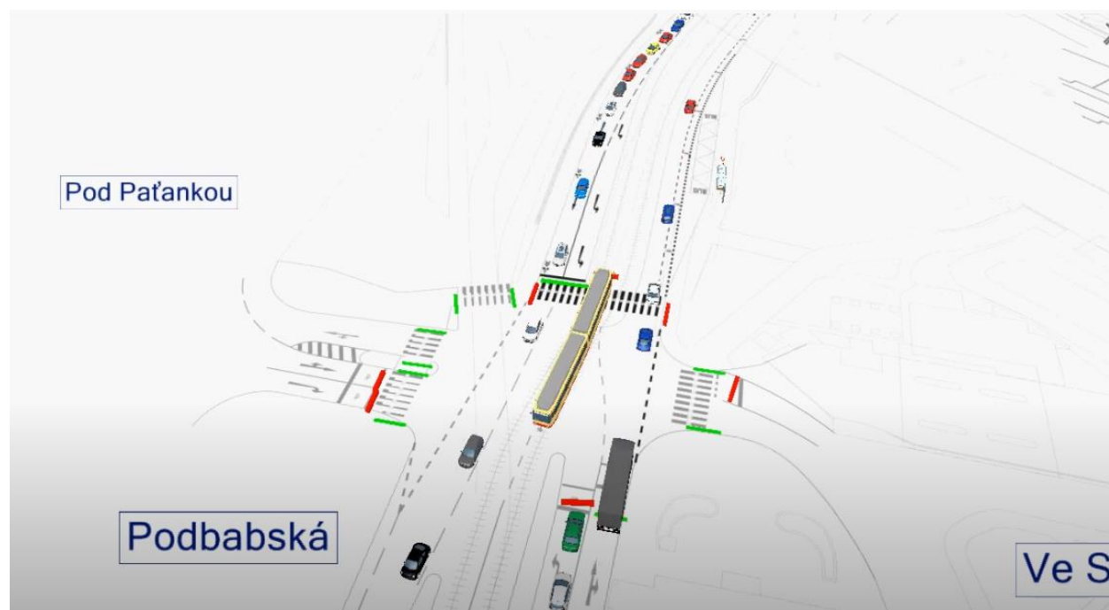
Obrázek 31: Křižovatka SSZ Podbabská – Ve Struhách - alternativa výstup kapacitního posouzení pomocí mikrosimulace
