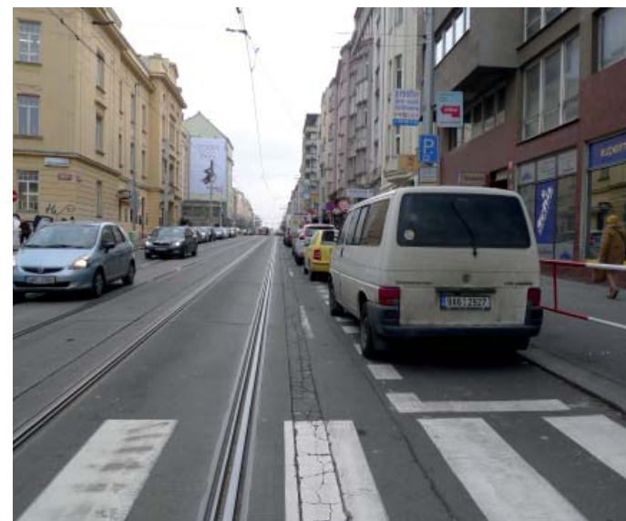
OBR 240.12 Současná parkovací stání ve vozovce V současné době auta parkují ve vozovce, ulice je tím nepřehledná a chodec na přechodu je hůř viditelný
