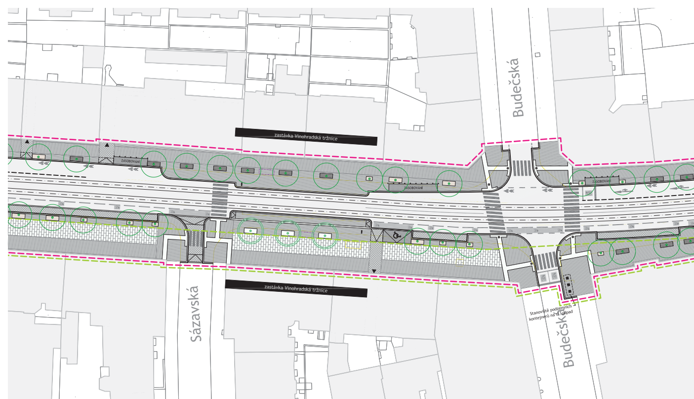
OBR 220.8 Zastávka Vinohradská tržnice Obě zastávky jsou navrženy ve vstříčné poloze proti sobě a jsou řešeny formou zastávkového mysu.
