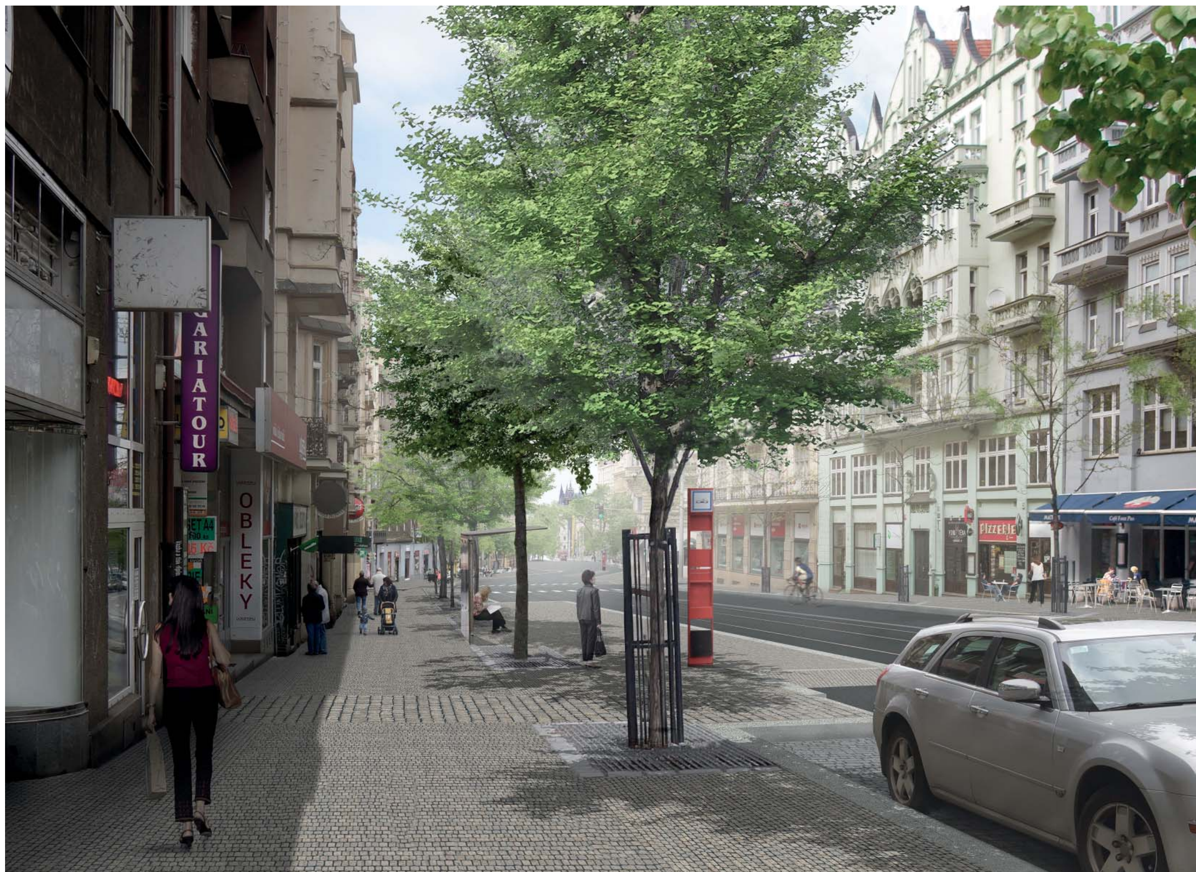
OBR 1.1 Vizualizace návrhu - zástavka Italská ve směru z centra Nástup do tramvaje probíhá bezbariérově přímo z rozšířeného chodníku.
