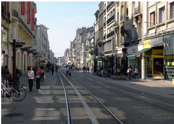
362 Příklad ulice v historickém centru města bez sloupů. Tramvaj je napájena z vodiče v zemi, osvětlení je umístěno na fasádě domů [ Francie, Remesš ]
