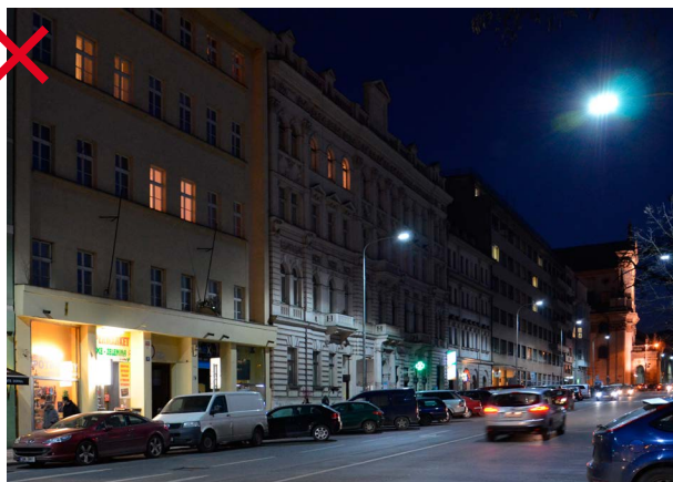
404 Veřejné osvětlení v centru města nevhodným chladně bílým světlem [ Praha 2, Karlovo náměstí ]
