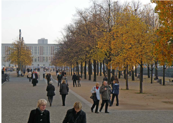
215 Mlatový povrch mezi stromy v kombinaci s dlažbou vytváří příjemné pobytové prostředí a umožňuje zasakování dešťové vody [ Německo, Berlín, Museumsinsel ]
