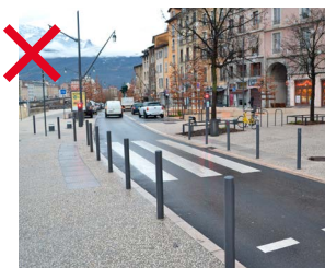
227 Velmi výrazné odlišení asfaltové vozovky od navazujícího pěšího prostoru ulice namísto sjednocení celkového profilu ulice je zpravidla méně vhodné [ Francie, Grenoble ]
