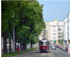
371 Trakční vedení v podobě sloupů s výložníky, které jsou umístěny v ose stromoadí [ Praha 6, Bělohorská ]
